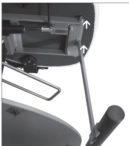
Bild 3. Befestigung der Fußstütze
