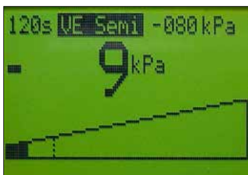
Fig. 20. VE Semi-Menu. L'unité tente de générer les -20 kPa de base.
