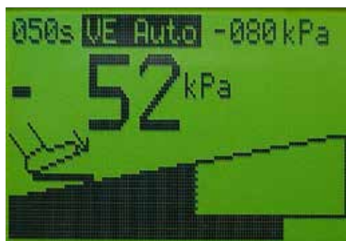
Fig. 31. Ex : valeur cible du vide -80 kPa Valeur réelle du vide -52 kPa
