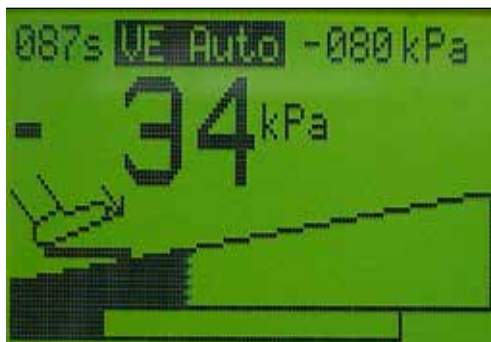
Fig. 29. Ex : valeur cible du vide -80 kPa Valeur réelle du vide -34 kPa
