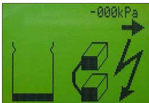
Fig. 32. Mise en garde de court circuit entre les pinces de contact, avec indication de la position du court circuit (ici: '→' au niveau des pinces de contact à droite)
