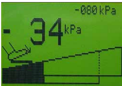
Bild 30. Bsp: Vakuum-Sollwert: -80 kPa Vakuum-Istwert: -34 kPa Fußglereinstellung: -34 kPa
