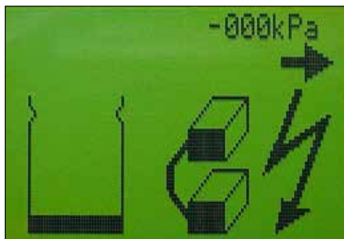
Bild 32. Warnmeldung für Kurzschluss zwischen den Kontaktklemmen mit Angabe der Position des Kurzschlusses (hier: '→' an Kontaktklemmen rechts)
