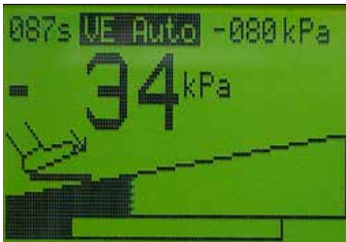
Bild 29. Bsp: Vakuum-Sollwert: -80 kPa Vakuum-Istwert: -34 kPa
