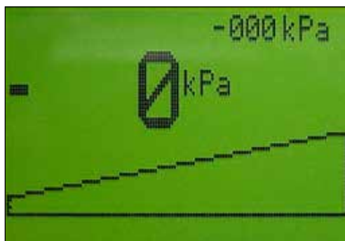
Bild 27. Anzeige nach Verlassen des jeweiligen VE Modus (z.B. nach erfolgter Belüftung)
