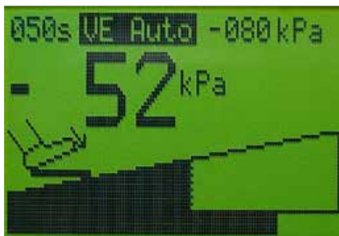
Bild 31. Bsp: Vakuum-Sollwert: -80 kPa Vakuum-Istwert: -52 kPa
