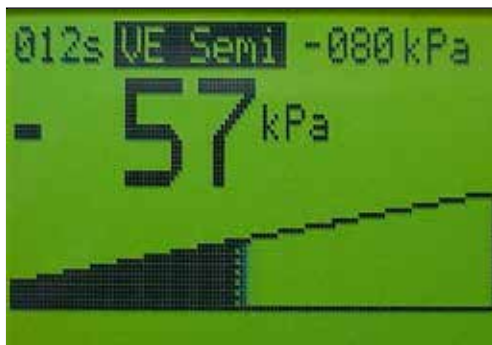
Bild 26. Automatischer Vakuumbau im VE- Semi Mode
